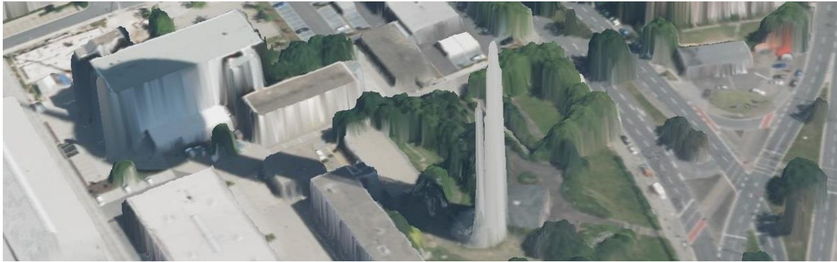
Abb. 3-12: Der Nürnberger Fernsehturm als RGB-TIN in Schrägansicht
