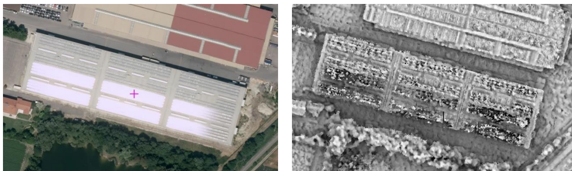
Abb. 3-10: Reflexionen im Luftbild. Links: DOP; Rechts: Streulicht-Visualisierung durch berechnete Umgebungsverdeckung (siehe Kap. 3.3.3)
