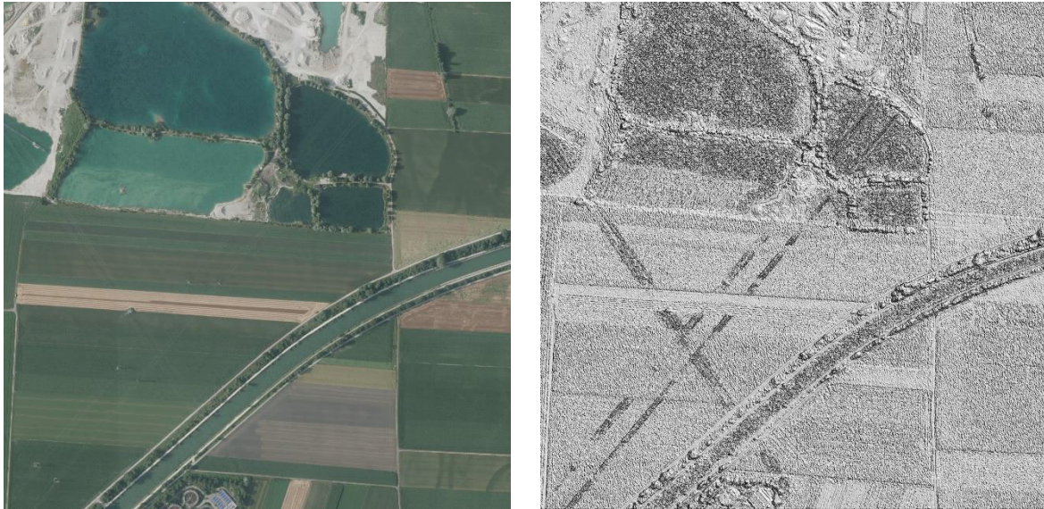
Abb. 3-9: Freileitungen des Stromnetzes. Links: Echtfarben; Rechts: Schräglightschummerung
