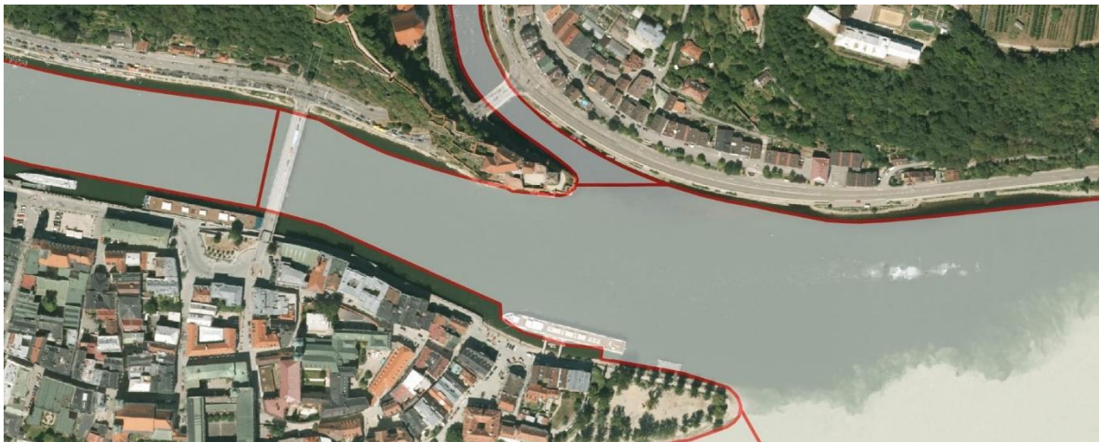
Abb. 3-30: Überlagerung des bDOM mit Gewässerpolygonen bei Passau (Rot ist die Uferlinie des Polygons)
